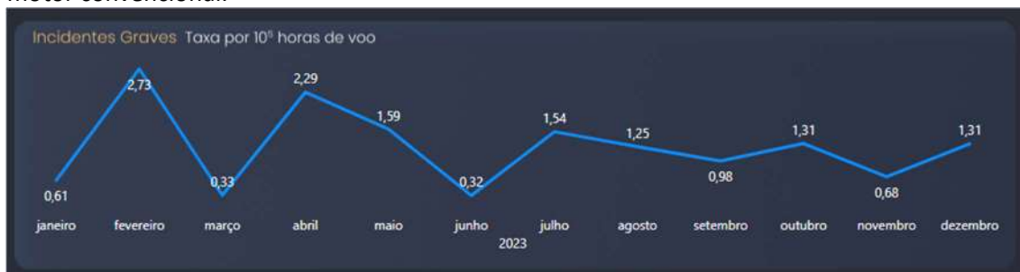
M6.2 Taxa de incidentes graves anuais, por 10 5 horas de voo, na operação de aeronaves com motor convencional.
